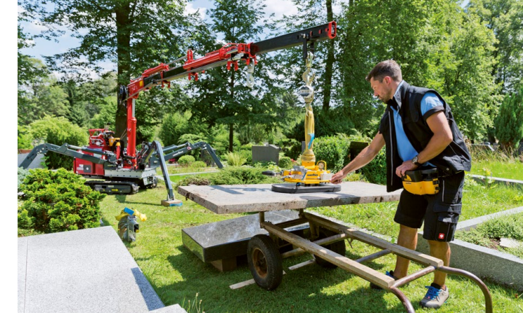
Bis zu 405 Kilogramm Last sind bei der maximalen Auslage von 7 Metern möglich.
