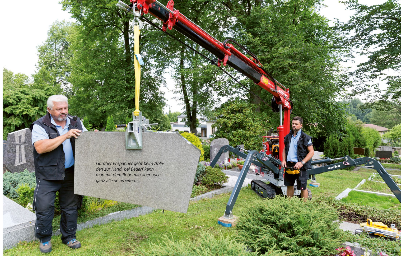
Bis zu 405 Kilogramm Last sind bei der maximalen Auslage von 7 Metern möglich.
