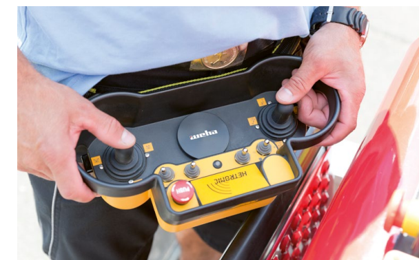
Die Fernbedienung steuert sämtliche Fahr- und Kranfunktionen des Roboman.
