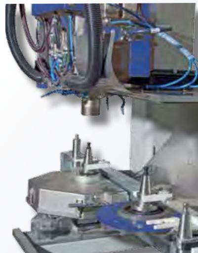
Unterflursäge mit Bohraggregat
