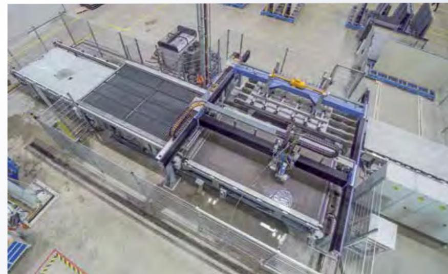
Automatisierte Keramikverarbeitung mit Wasserstrahl
