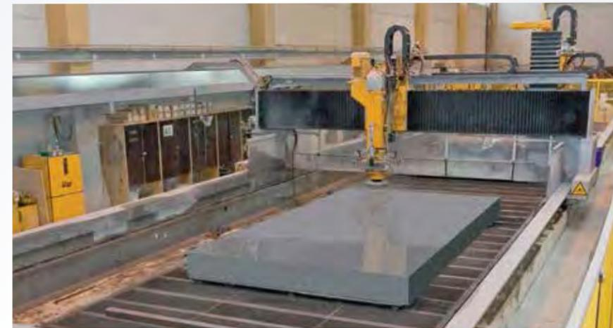
Für die Bearbeitung großformatiger Betonfertigteile bieten wir individuelle Lösungen an. Die Baureihe FR FS mit automatischem Kopfwechsel wird zum Fräsen und Schleifen von Betonpanelen eingesetzt. In Kombination mit einem 5-Achs Bearbeitungssupport können Fenster- und Türleibungen und die Werkstückseiten präzise bearbeitet werden.
