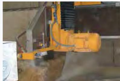
Direkt angetriebene Sägewelle
