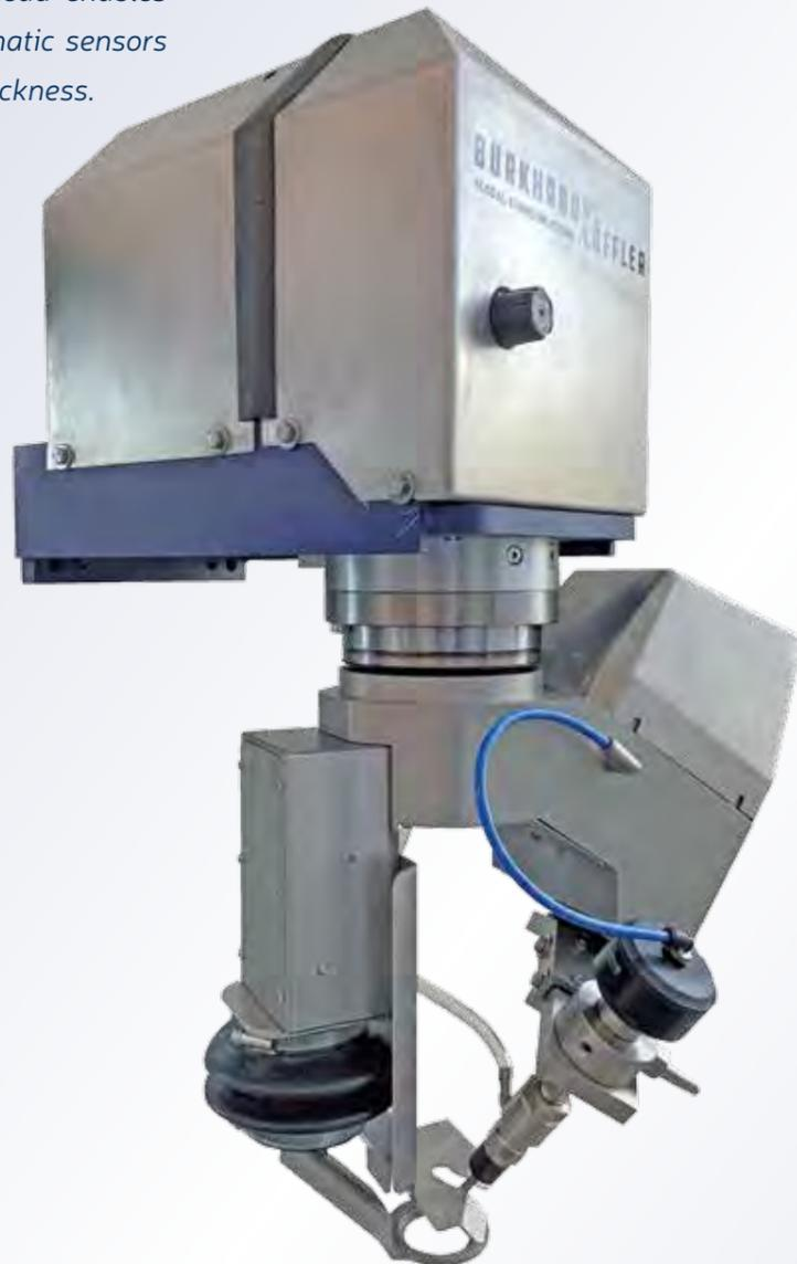
Selbst entwickelter 3-D Wasserstrahlkopf
