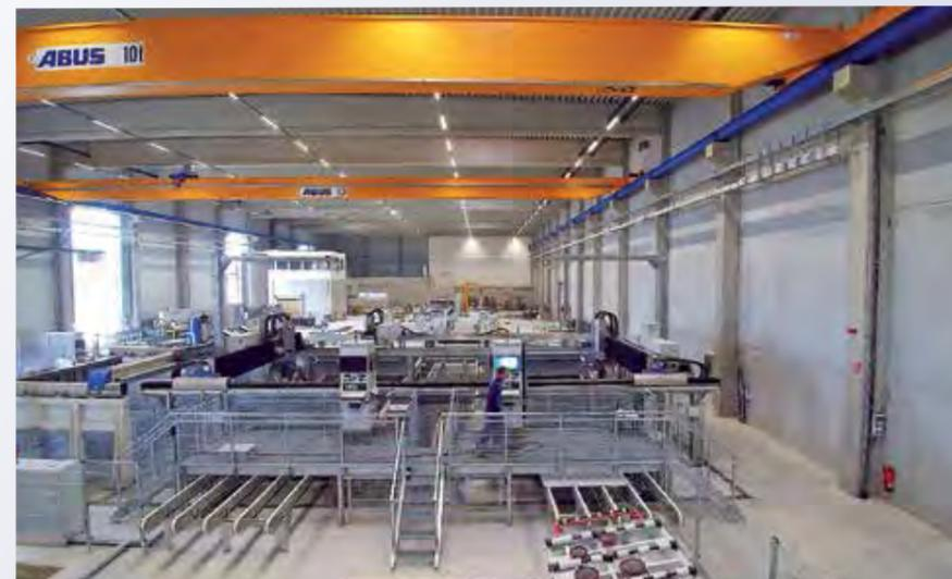
Flexible Fertigungsanlage für Ofenverkleidungen
