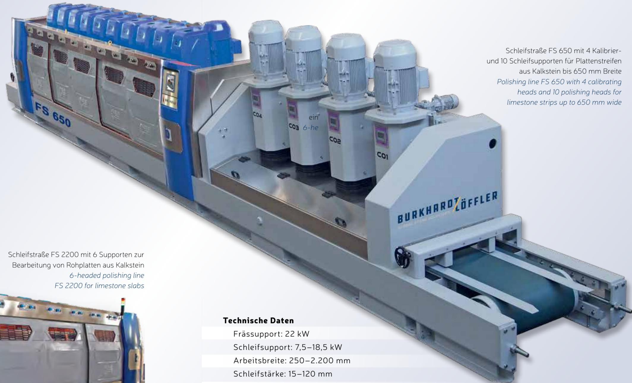
Schleifstraße FS 650 mit 4 Kalibrier- und 10 Schleifsupporten für Plattenstreifen aus Kalkstein bis 650 mm Breite
