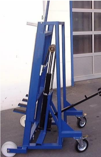
Abbildung 1 Gesamtansicht Gravierbock hydr. verstellbar
