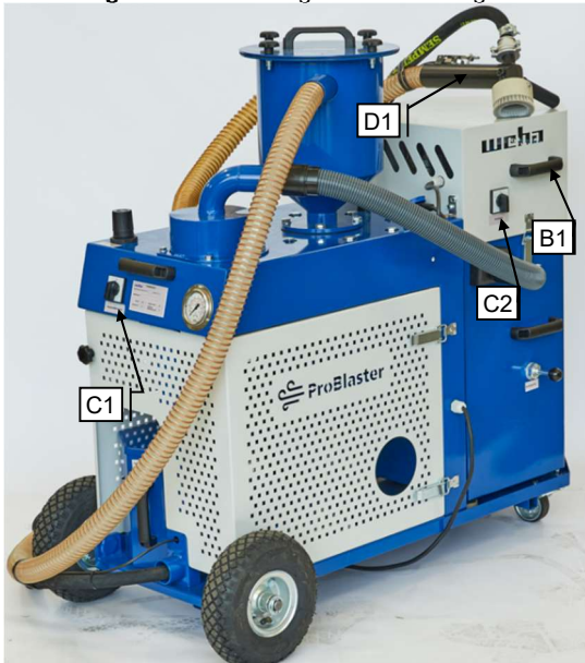
Abbildung 6.1 - Vorbereitung des Sandstrahlgeräts
