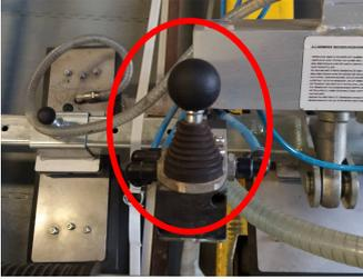
Mit Hilfe des Manipulators kann die Platte zwischen waagrecht und senkrechtem Zustand hin- und hergeschwenkt werden. Drücken sie dazu den Manipulator nach vorne bzw. hinten.
