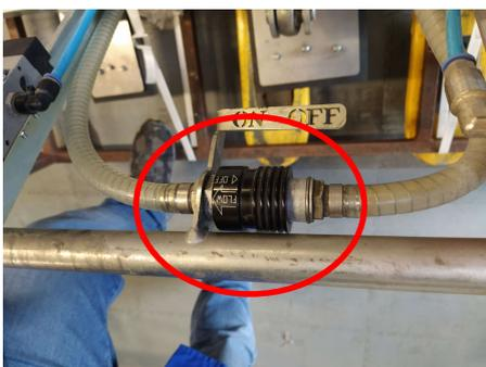
Befinden sich alle Hähne in der korrekten Position, schieben sie das Handschiebeventil aus Bediener-sicht nach links.
