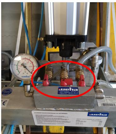
Jeder der hier gezeigten Hähne regelt die Vakuumversorgung für eine der Saugplatten.
