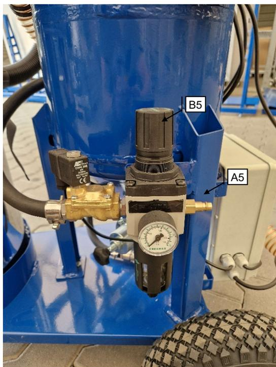
Abbildung 6.5 - Druckluftanschluss Sandstrahlgerät
