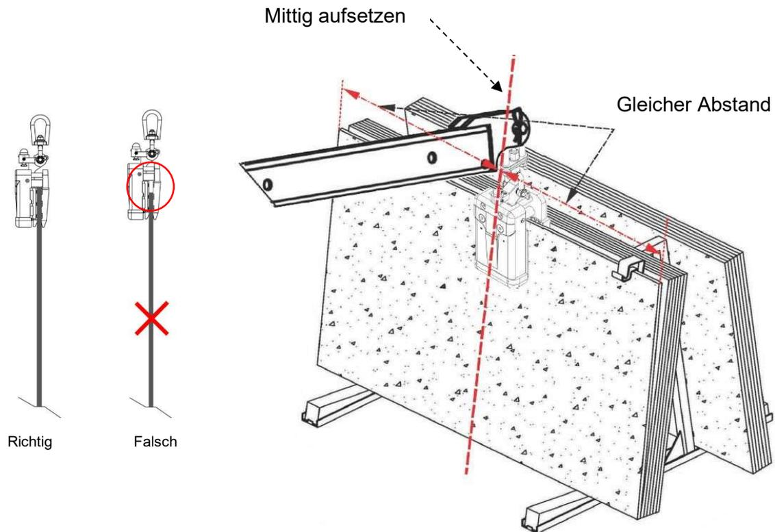
Heben Sie langsam die Steinplatte an. Dabei schließt der Mechanismus die Klemmbacken. Nun kann die Platte versetzt werden.
