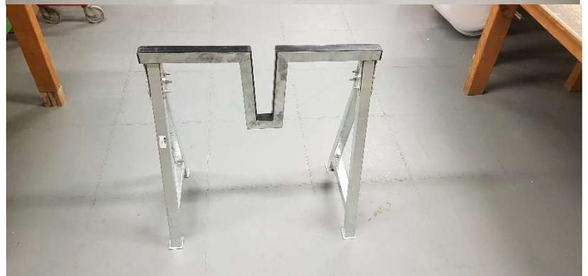
3. untere Strebe einstecken mit den 4 mitgelieferten, kürzeren Schrauben verschrauben
