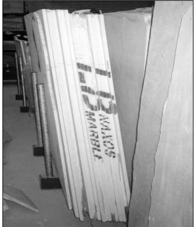
**Abbildung 6.5** - Zu geringer Anstellwinkel bei zu großer Gesamtplattendick
