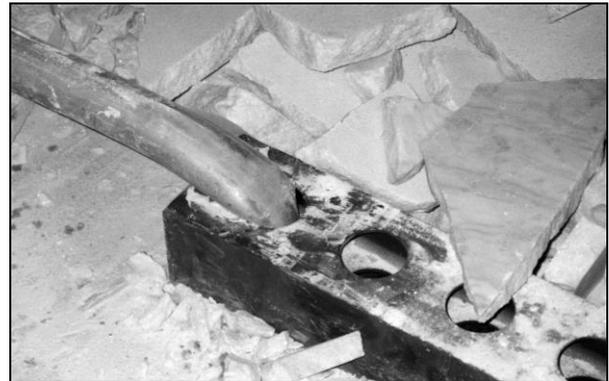
**Abbildung 6.7** - Geknicktes Eisenrohr durch Überbelastung
