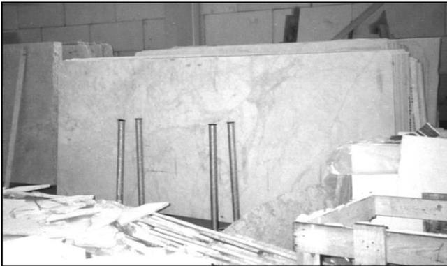
**Abbildung 6.6** - Überbelastete Eisenrohre, Bruch- bzw. Knickgefahr
