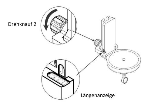
Schritt 3: Das Anbringen der Spannvorrichtung an der Arbeitsplatte
