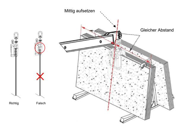
Heben Sie langsam die Steinplatte an. Dabei schließt der Mechanismus die Klemmbacken. Nun kann die Platte versetzt werden
