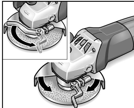
2. Aflojar la palanca de montaje.
