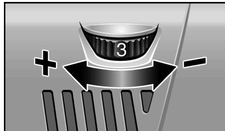
Radi namještanja radnog broja okretaja kotač za namještanje postaviti na željenu vrijednost.
