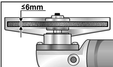
7. Spannmutter (3a) mit dem Bund nach oben auf die Spindel schrauben.
