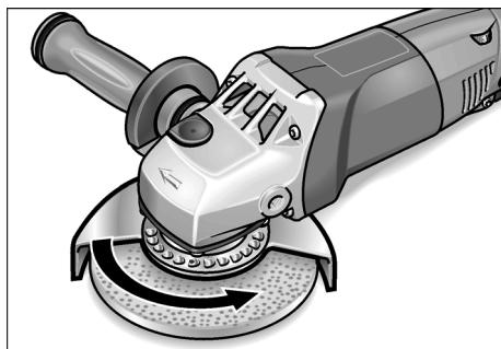
2. Zabezpieczającą osłonę tarczy (4a) przekręcić w kierunku przeciwnym, niż wskazuje strzałka na korpusie napędu (7), aż do odpowiedniej pozycji.
