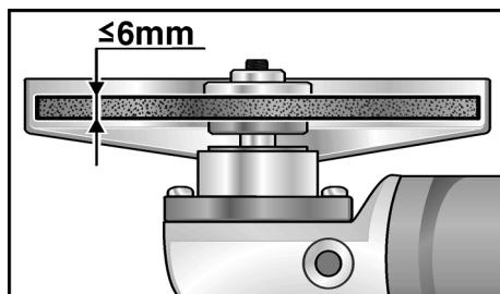
7. Skru spændemøtrikken (3a) på spindlen med brystet opadvendt.
