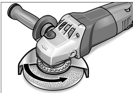
2. Drej sikkerheds-beskyttelseshætten (4a) i modsat retning af omdrejningsretningsspilen på gearhovedet (7) og hen til ønsket position.
