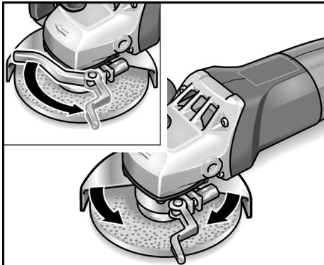
2. Desapertar a alavanca de fixação.
