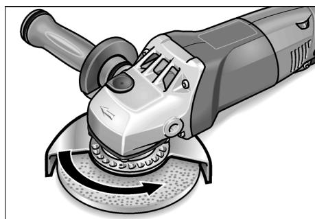
2. Ruotare la cuffia di protezione di sicurezza (4a) in senso contrario alla freccia del senso di rotazione sulla testa ingranaggi (7) fino alla posizione necessaria.
