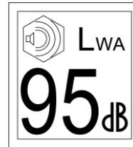
2.1. CE-Markierung und Geräuschkleber: Dies sind Beispiele von einem ELMAG Typenkleber und Geräuschkleber. Den Typenkleber mit CE-Markierung finden Sie an jedem Aggregat. Den Geräuschkleber finden Sie nur dann, wenn das Aggregat der europäischen Geräuschkategorie 2000/14/EC entspricht. Für mehr Informationen darüber lesen Sie auch die ELMAG Dokumentation oder gehen auf unsere Website [www.elmag.at](http://www.elmag.at).
