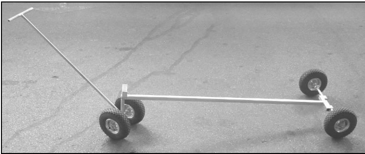
Abbildung 4.3 Zugwagen für die Baugruppen des Portalkrans Picco
